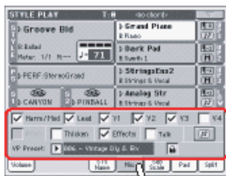
Переключатели "master" голосового процессора. Для мониторинга уровня сигнала микрофона отмените выделение полей Harm/Model, Pitch, Thicken, Effects, Talk, Mic Mute.
