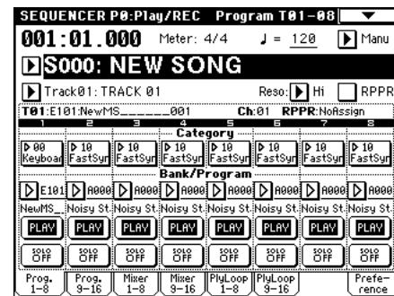
☞ Если при создании данных трека параметр “Start Measure” установлен в значение, отличное от **001**, то параметры и программы страницы P0: Play/REC, PlayLoop T01 — 08 автоматически не устанавливаются (параметр “Track Play Loop” устанавливается в значение **Off**, и в начальной позиции такта “Start Measure” формируется сообщение формата *Program Change*).
