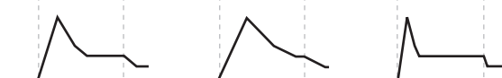
Слабое взятие ноты. Оригинальная кривая. Сильное взятие ноты. Длительности больше. Достижение Sustain медленнее. Сильное взятие ноты. Длительности меньше. Достижение Sustain быстрее.
