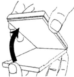
Нажимая на участки по обеим сторонам корпуса, обозначенные словом OPEN, откройте крышку и осторожно вставьте батареи, соблюдая полярность. Срок службы батарей может различаться в зависимости от условий использования. Если устройство проявляет признаки неисправности, и выключение (положение OFF) и включение (положение ON) питания не сняло
